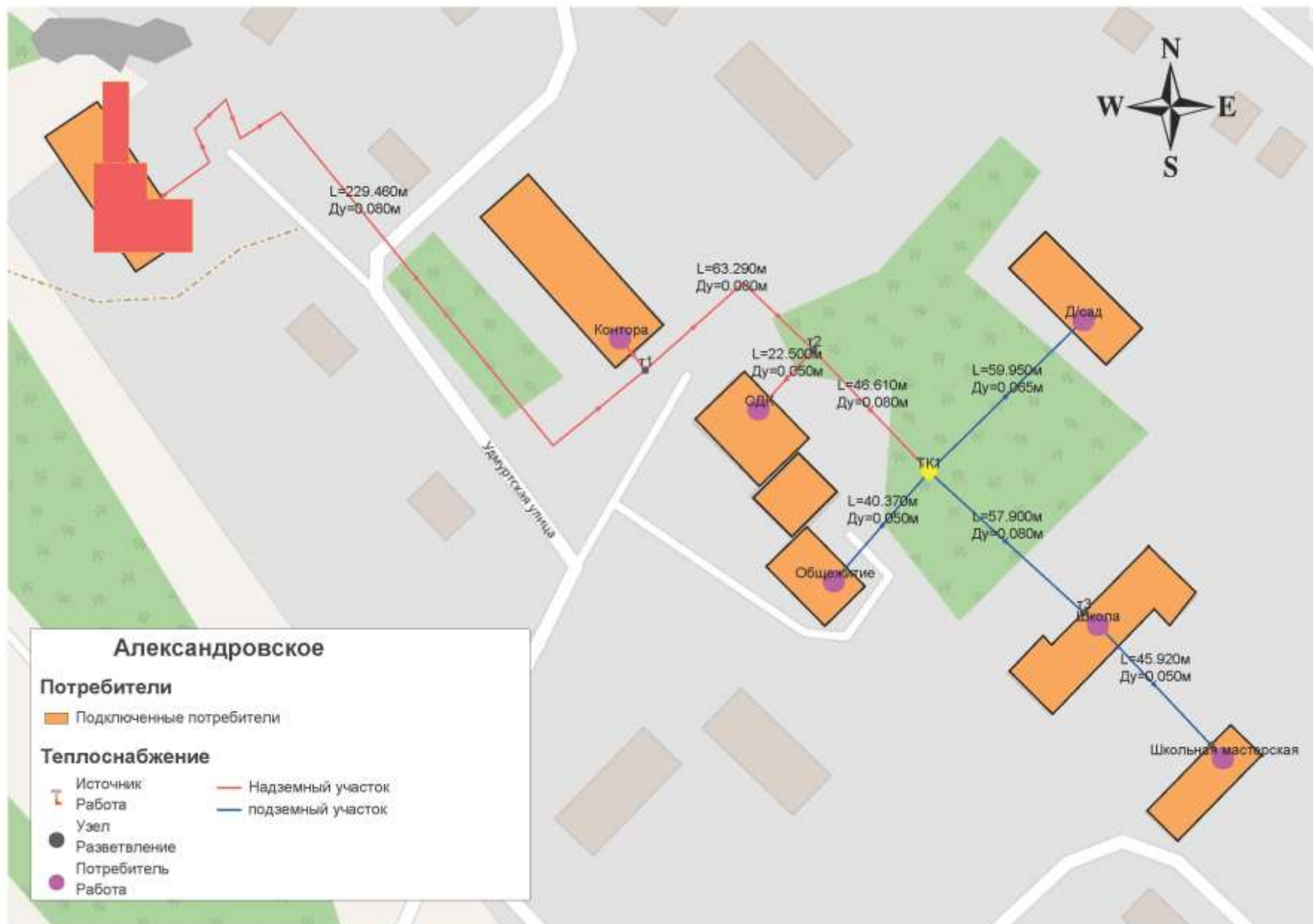
Рисунок 2. Принципиальная схема места расположения источника тепловой энергии – котельная №7 с. Александрово
